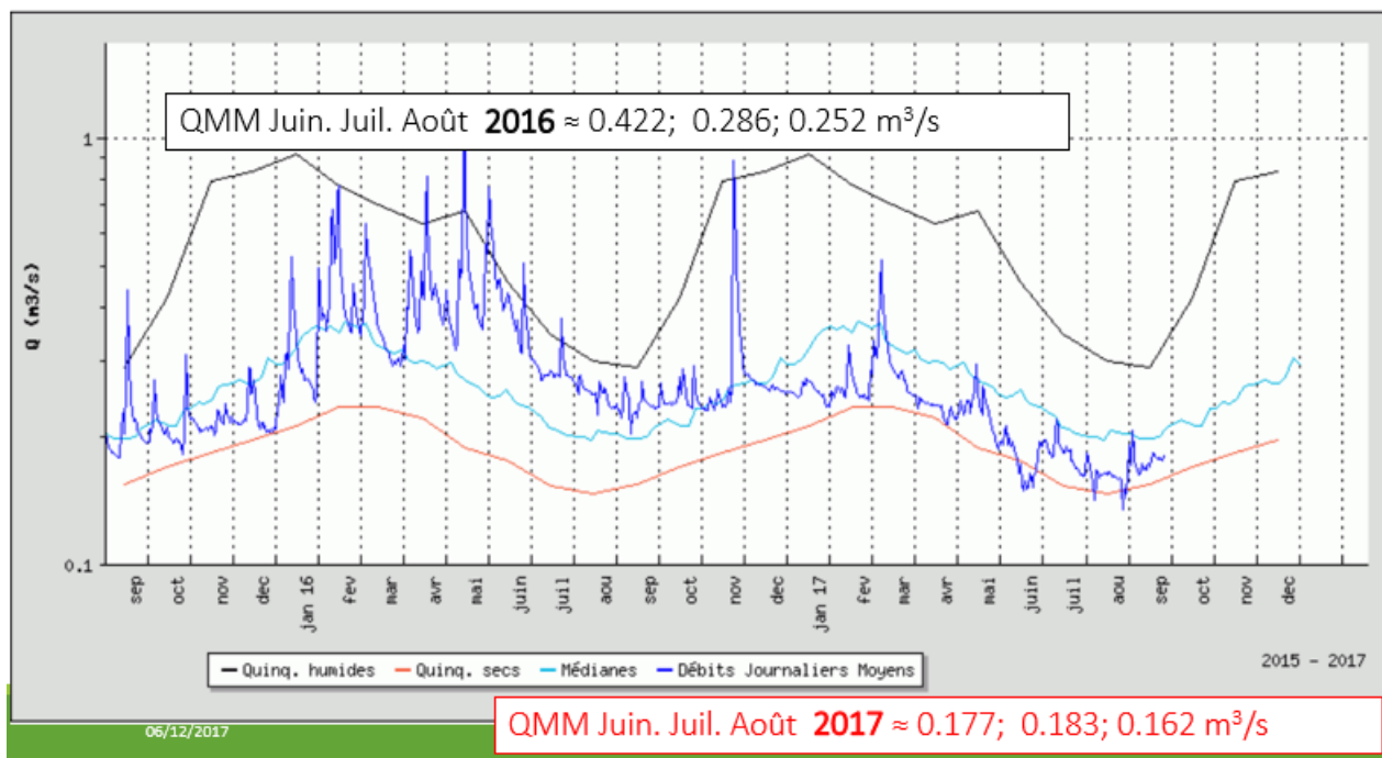
Figure 1 : Suivi du débit de la Cent Fonts à la station hydrométrique de Saulon-la-Rue (données Banque Hydro)
