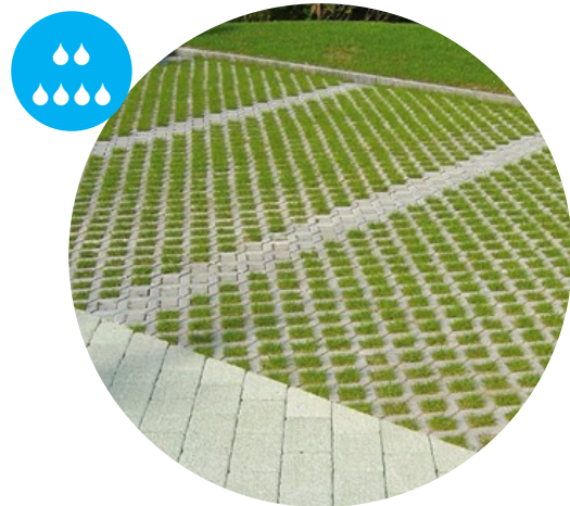
Configuration 6 : Aménagement d'un parking avec revêtements perméables
